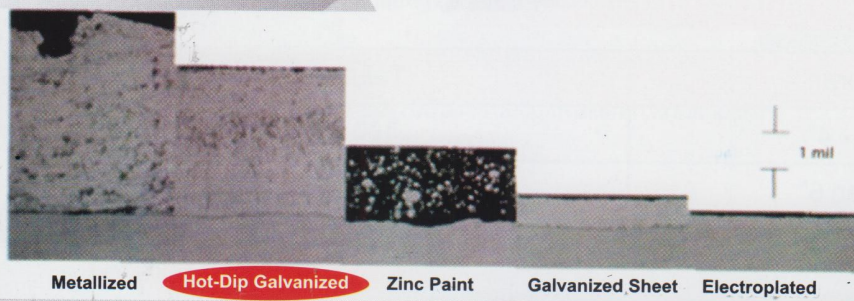
Gambar Mikrostruktur untuk beberapa pelapisan Zinc.
